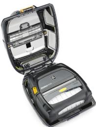
Verbessert Fallfestigkeit auf 3 m/10 Fuß, dichtet Anschlüsse ab und erhöht die Schutzart auf IP65 zur Verwendung unter extremen Umgebungsbedingungen. Kann mit einzelnen und Erweiterungsakkupacks, Vierfach-Druckerladestation und Einfach-Ladestation verwendet werden.
